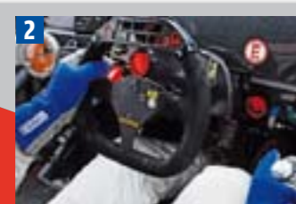
Cockpit: (1) Verstellknopf der Startautomatik mit 9 Stufen. (2) Flaches Lenkrad wie im Formel-Flitzer. (3) Sicherheitstank als Beifahrer. (4) Wenig Platz im Fußraum (5) Der Arbeitsplatz des Fahrers ist richtig eng
