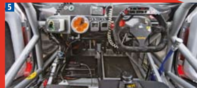
Cockpit: (1) Verstellknopf der Startautomatik mit 9 Stufen. (2) Flaches Lenkrad wie im Formel-Flitzer. (3) Sicherheitstank als Beifahrer. (4) Wenig Platz im Fußraum (5) Der Arbeitsplatz des Fahrers ist richtig eng
