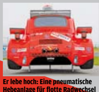
Windspiel: Der Diffusor unterm Heck sorgt für Anpressdruck
