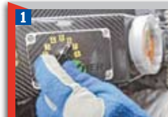
Cockpit: (1) Verstellknopf der Startautomatik mit 9 Stufen. (2) Flaches Lenkrad wie im Formel-Flitzer. (3) Sicherheitstank als Beifahrer. (4) Wenig Platz im Fußraum (5) Der Arbeitsplatz des Fahrers ist richtig eng
