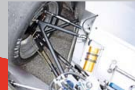
Professionell: Vorderradaufhängung mit vom Cockpit aus verstellbarem Stoßdämpfer
